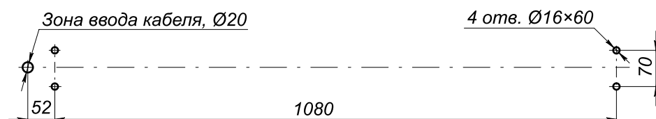
Разметка отверстий для монтажа калитки
